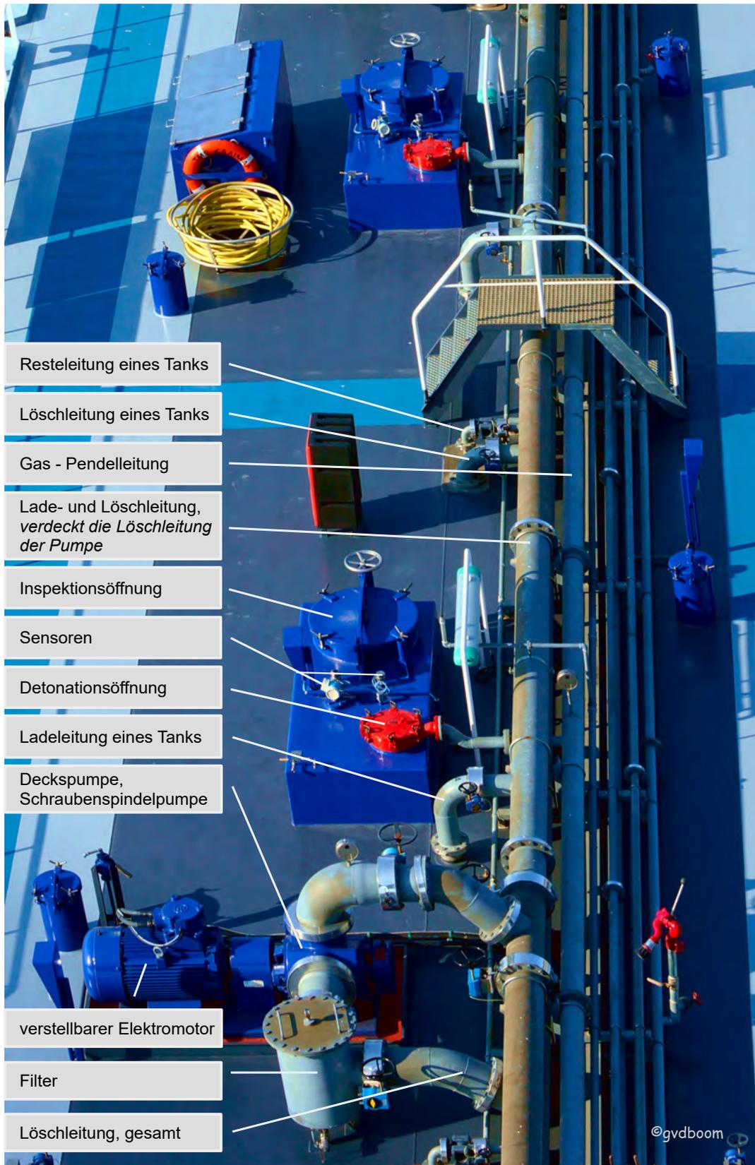
Abb. 5: Tankdeck mit Ladungspumpe auf dem Deck
